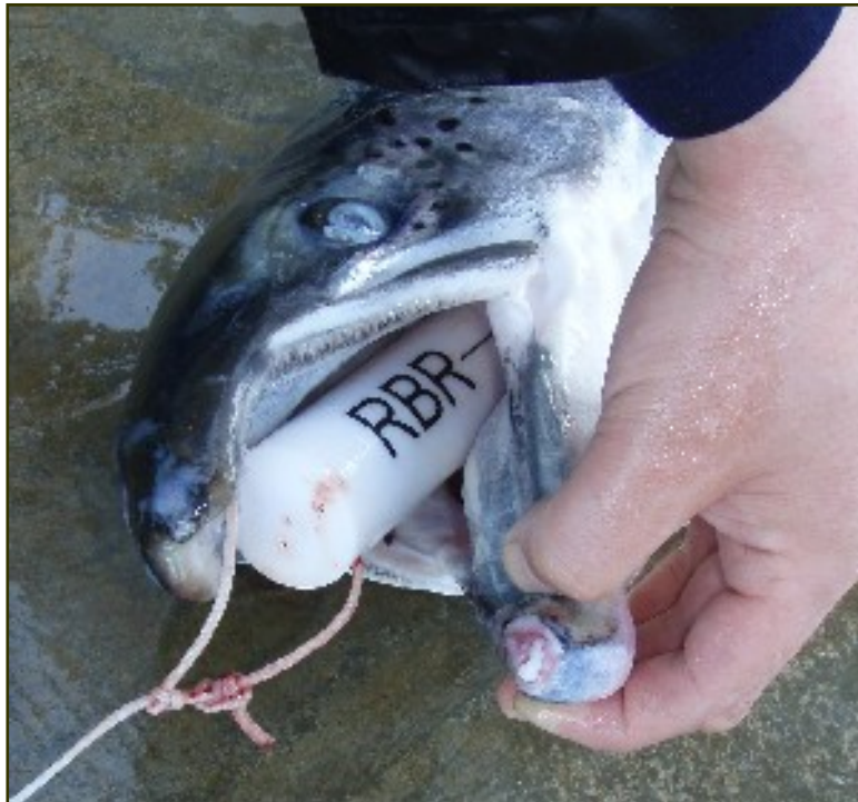
Bilde 17 Trykksensoren ble lagt ned i den døde laksens mage.
